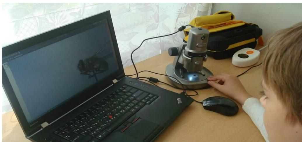
Учащиеся 16 класса с помощью цифровой лаборатории Архимед, регистратора данных NOVA5000, датчика влажности повышенной точности, исследуют влажность атмосферного воздуха.
